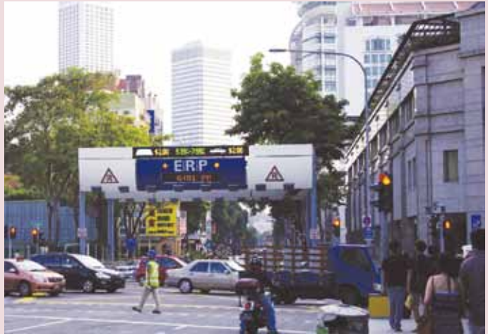
▲ Ở Singapore, các cổng điện tử kiểm tra để đảm bảo xe ô tô chạy trong khu trung tâm đã đóng phí vào khu vực này
