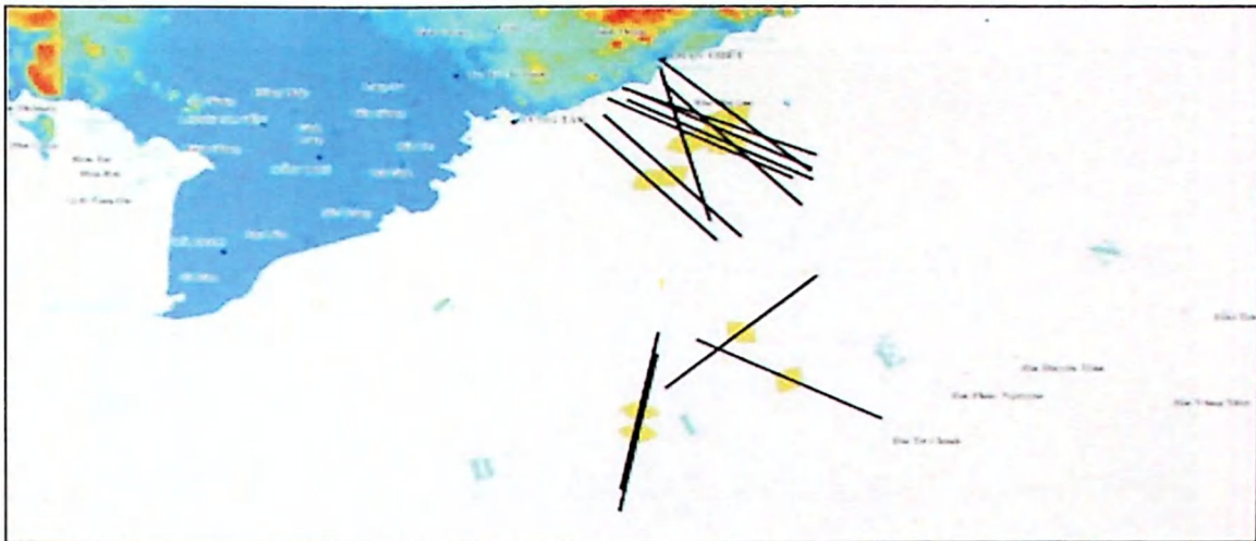
Hình III-27. Kết quả tổng hợp xác định định hướng của trục nén ép ngang cực đại từ tài liệu ảnh lỗ khoan được thể hiện trên bản đồ
